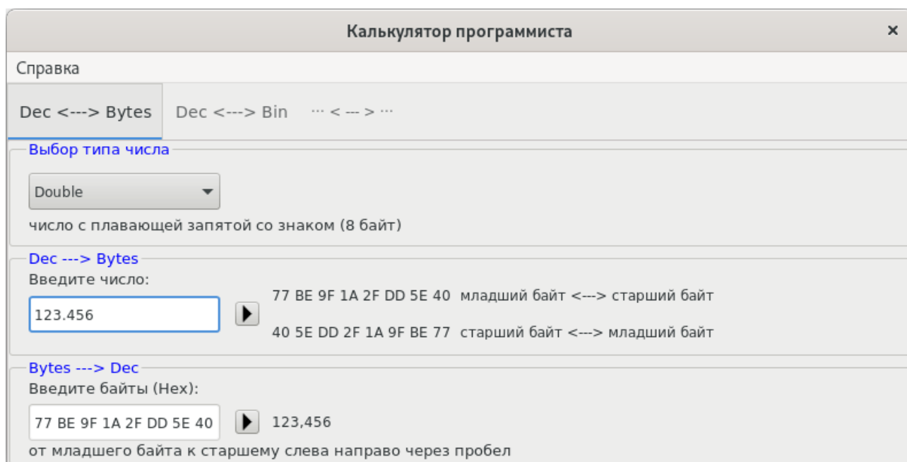
Рис 1. Преобразование десятичного числа в байты и обратно
